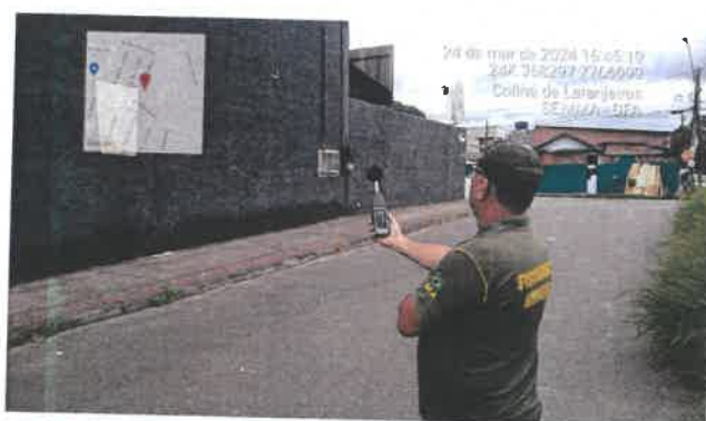
Foto 04 – ajuste do sonômetro para medição do nível de pressão sonora do som residual
