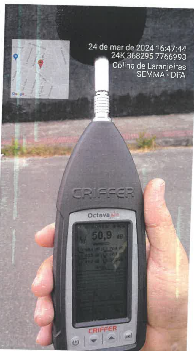
Fotografia 5, 6 e 7: Local da medição da pressão sonora do som residual. Medição do som residual LAeqT= (48,1 dB)
